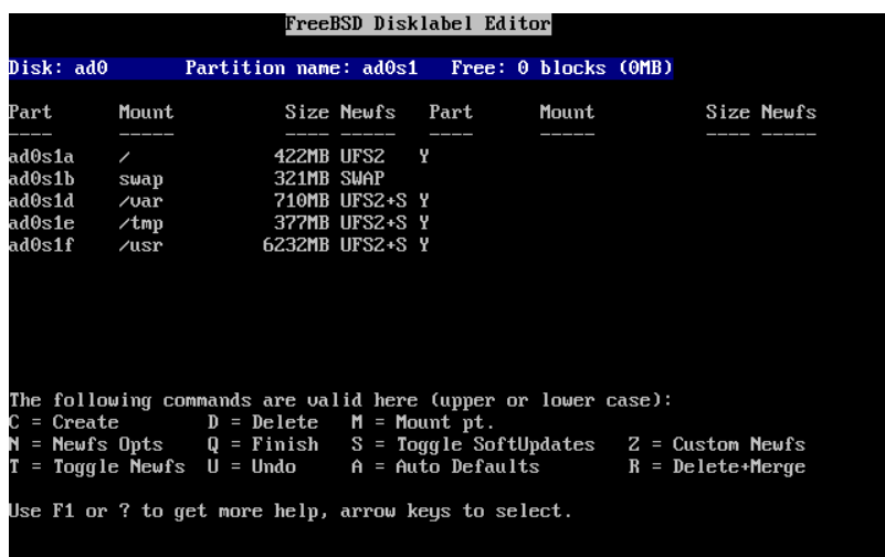
2.20. ábra - A sysinstall Disklabel partíciószerkesztője, alapértelmezett értékekkel
